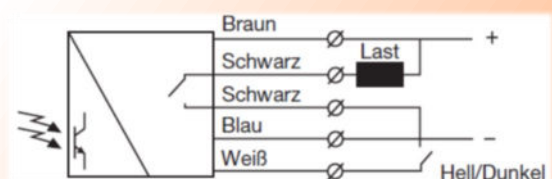
Empfänger Anschluss als NPN
